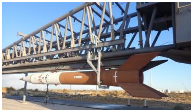
Le lanceur et sa rampe de lancement
